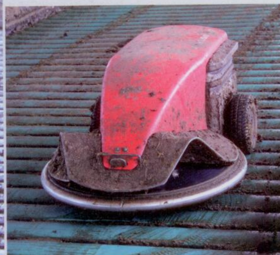
Een mestrobot of -schuif is ook mogelijk op een Groene Vlag-vloer.
